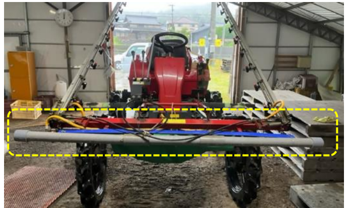
散布ノズル前の塩ビパイプ設置
