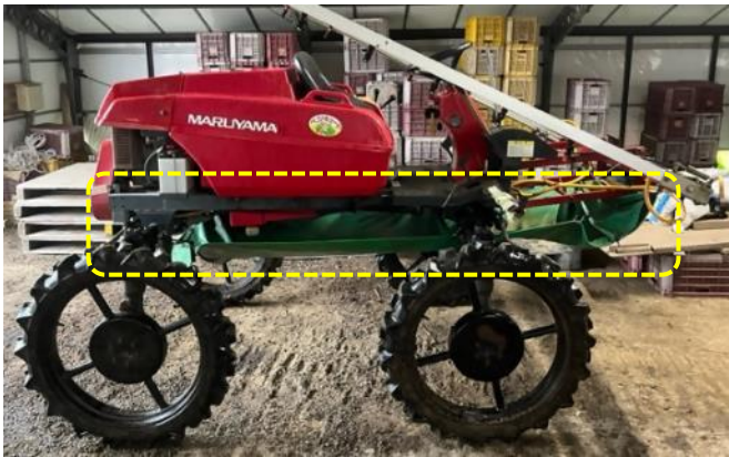
機体下部に厚手のシート設置
