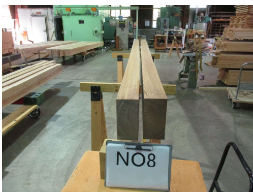
図2 芯去り梁桁材
