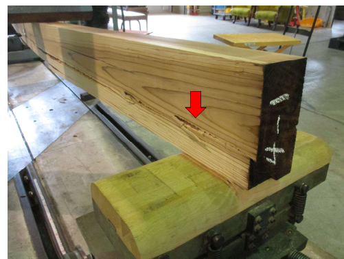
図3 芯去り梁桁材のせん断破壊
