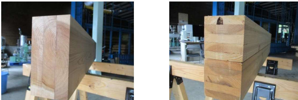
図1 接着合わせ材（左）と集成材（右）の違い
