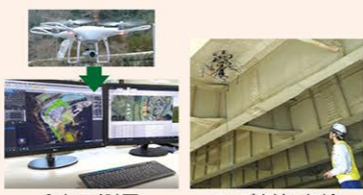
3次元測量 ひび割れ点検 UAVの活用
