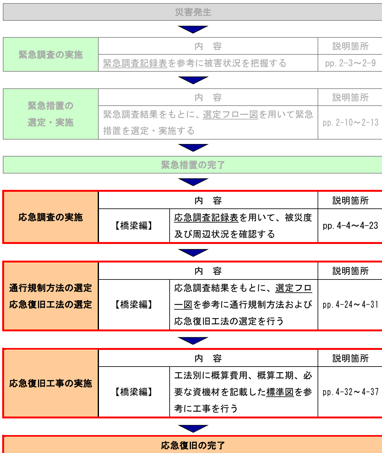
図 4-1-2 応急復旧（橋梁編）の基本的な流れ
