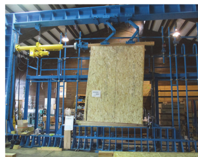
図5 壁試験の状況
