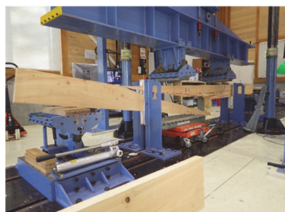
図2 曲げ試験の状況
