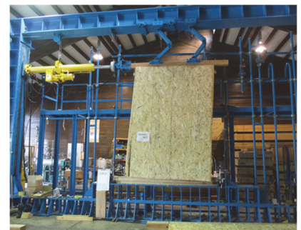
図5 壁試験の状況
