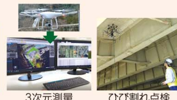
3次元測量 UAVの活用
