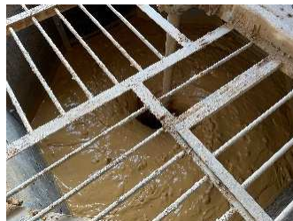
②高速攪拌機にかけ、不純物を除去
