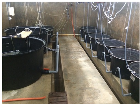
図 3 試験風景（収容密度を変えて飼育水中の DNA 量を測定する）
