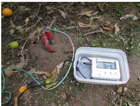
調査園に設置した土壌水分センサー
