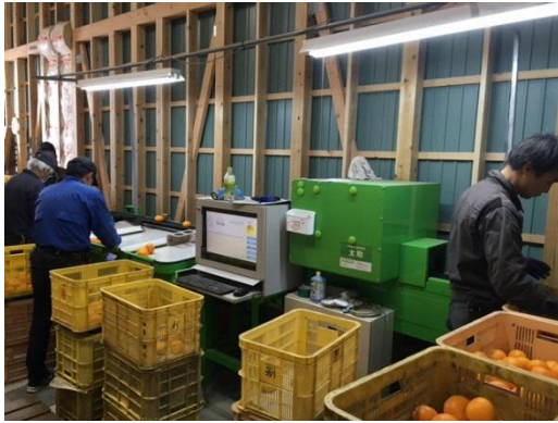
写真右でレーンに乗せた果実は中央部で画像処理され、左の2人がコンテナに詰める。
