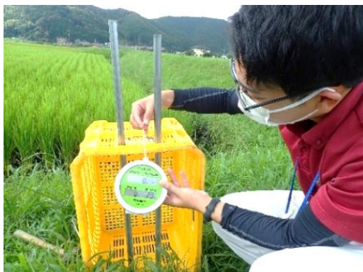
直射日光を避けコンテナ内に設置
