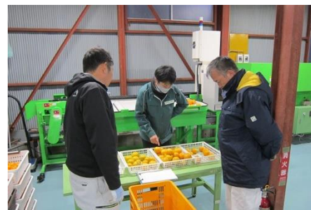
AI選果機による正解率・再現率の確認
