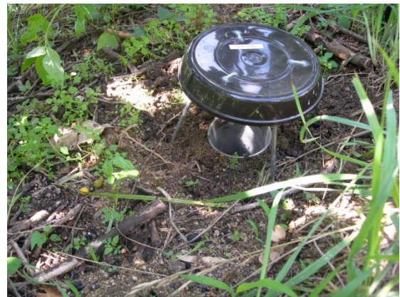
写真1 PFTの設置状況
