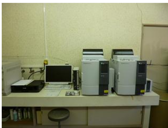
成熟・老化分析装置（果樹研究センター） エチレン生成量や呼吸量等の成熟・老化に関する生理状態を分析する装置
