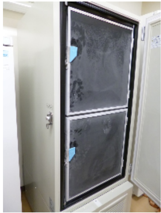
開閉時の冷気漏れを防ぐ2分割内扉
