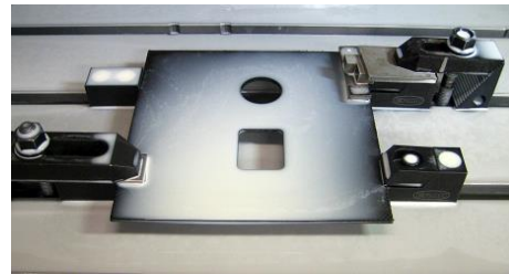
写真 2 加工直後の CFRP
