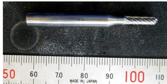
写真 1 エンドミル（使用前）（スケール 1 目盛：1mm）
