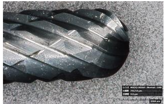
写真 15 15回加工後の超合金製工具
