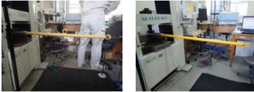
図2 ポータブルスタクション物性評価方法 (左: 金属製、右: CFRP 製)
