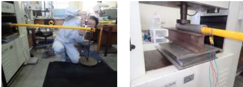
図3 ポータブルスタクション物性評価方法 (左: たわみ量測定、右: ひずみ量測定)
