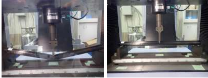
図 11 CFRP パイプの 3 点曲げ試験（左列：最大押込時、右列：除荷後）
