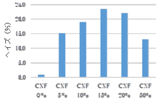
図5 ヘイズ測定結果 (ウレタン樹脂/CNF)
