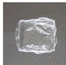
図4 ガラス/CNF 接着部
