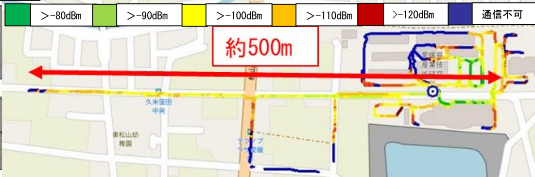
敷地外電波強度測定
