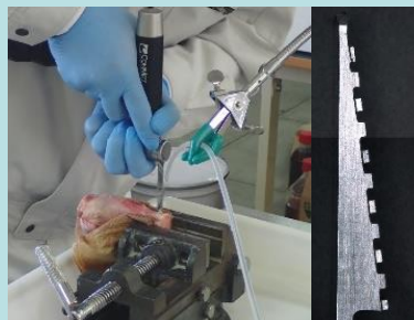
(左) 豚骨を用いた切除試験 (右) 顕微鏡による観察
