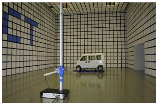
写真4 放射ノイズの測定
