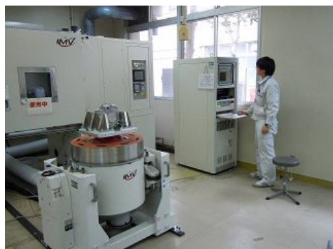
写真5 主要コンポーネントの振動試験
