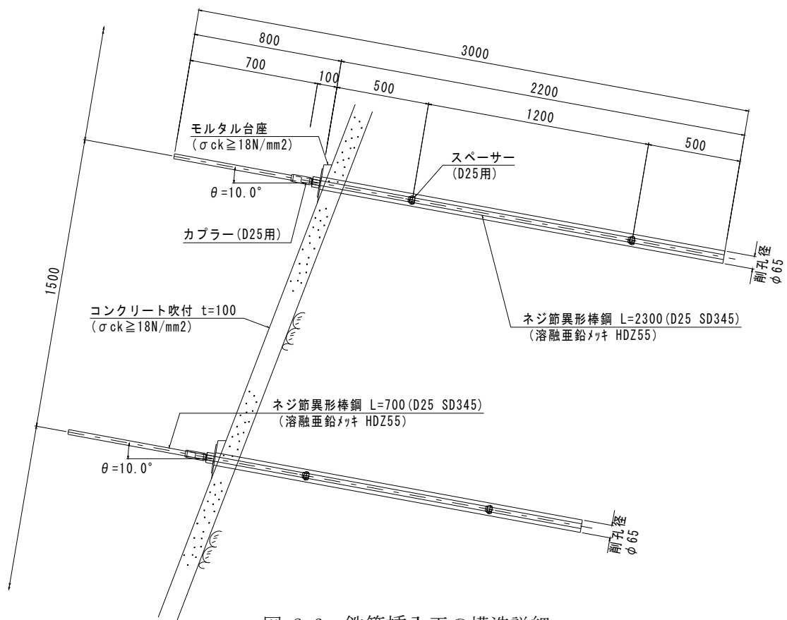
図-2.6 鉄筋挿入工の構造詳細
