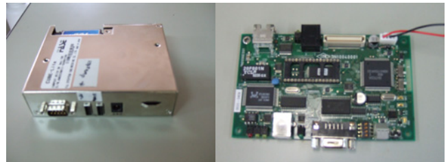
図1 Linux 装置(左)と \mu TRON ボード(右)
