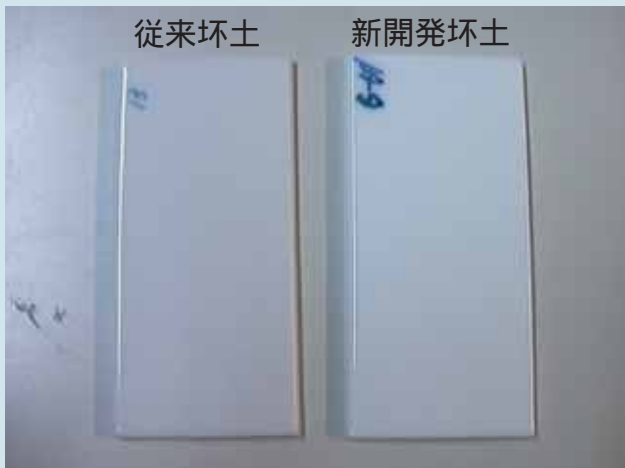
焼成試験体の白色度比較結果
