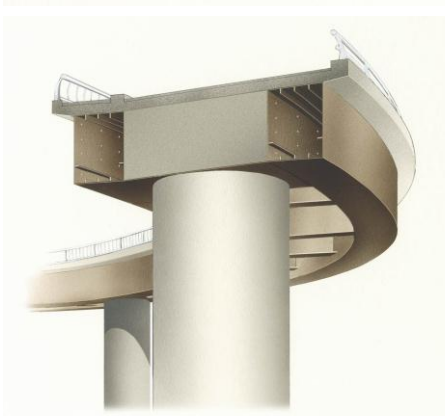
鋼箱桁橋脚剛結部
