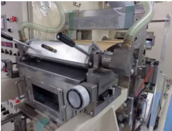
コーターによる CNF 塗工試作
