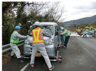
車両移動 (ゴージャッキ使用)
