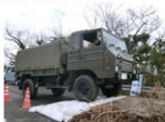
段差すりつけ (土のう使用)
