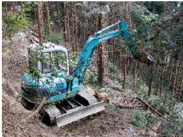
グラブローダによる木寄せ作業 林内路網密度を高めて木寄せ距離の短縮
