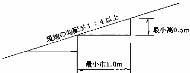
図2-1 盛土基礎地盤の段切
