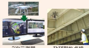
3次元測量 ひび割れ点検 UAVの活用
