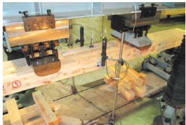
小径ラミナを使用したヒノキCLTのせん断試験状況
