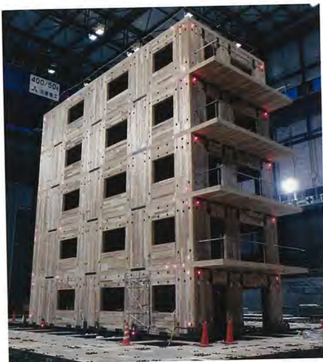
E-ディフェンスでの実大震動台実験（兵庫県三木市）
