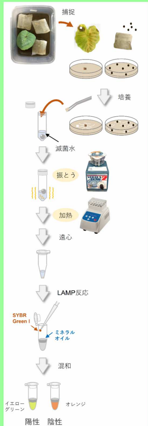
図5. 捕捉法とLAMPを組み合わせた土壌からの検出
