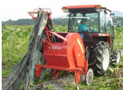
マルチ除去作業
