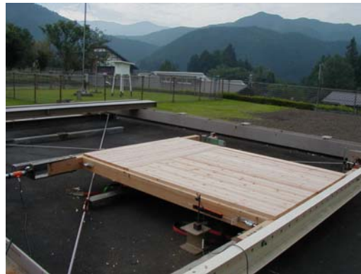
写真-2 県産スギ床材の水平せん断試験試験状況
