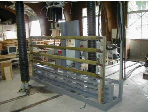
写真-1 スギ間伐材による歩行者自転車木製柵の試験状況
