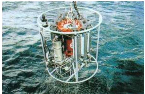
ICTD システム 水深、水温、塩分を測定し、任意の水深で採水できる。
