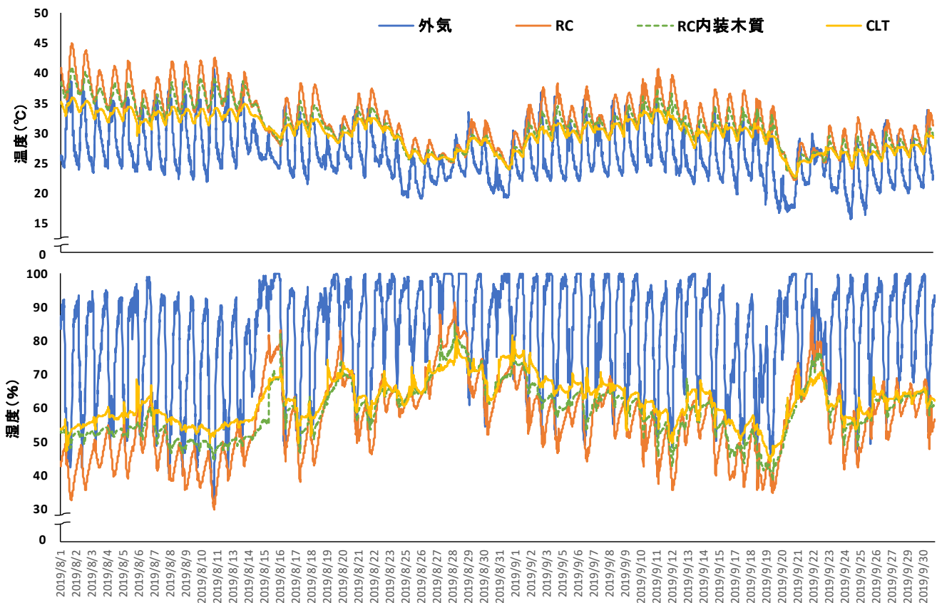
CLT建築物とRC建築物における温度(上)および湿度(下)の変化(2019年8月~9月)
