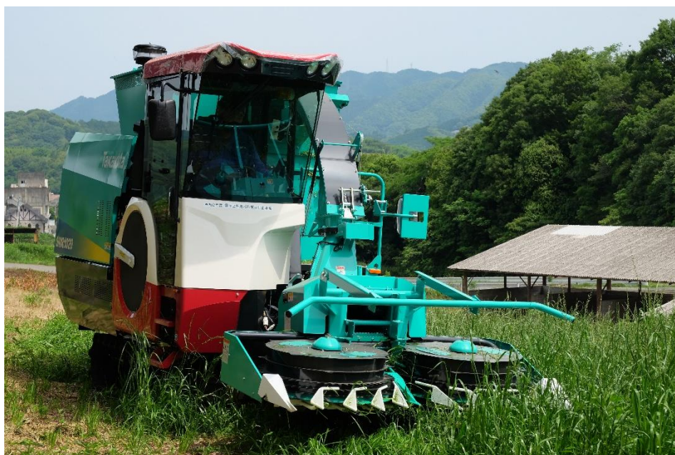
高品質なサイレージ調製が可能な汎用型微細断飼料収穫機
