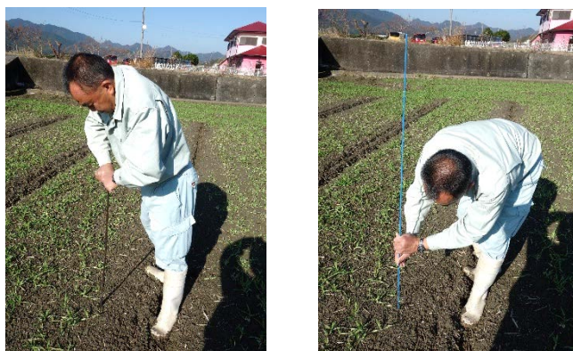
図 4-3 有効土層深の測定(左:検土杖、右:ダンポール)
