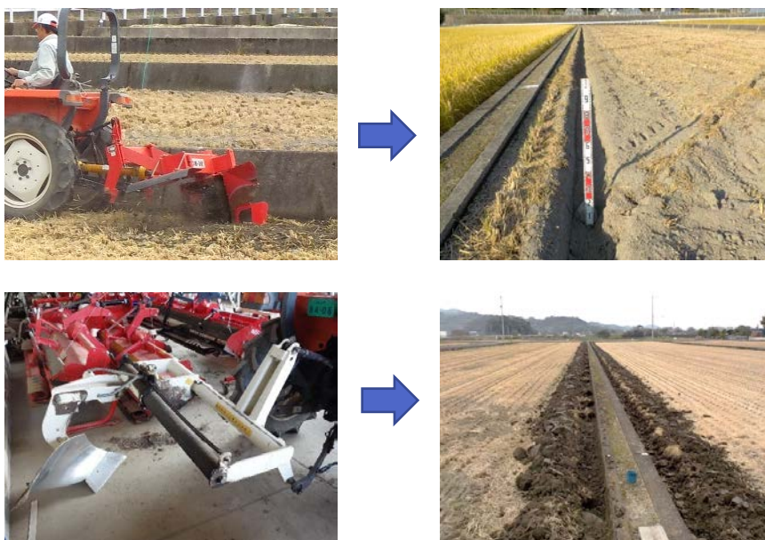
図 4-4 作業機と施工した明きよ(上:溝堀機、下:プラウ)
