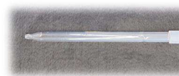
写真2 簡易検定手法に使用したパスツールピペットを加工した吸虫管
