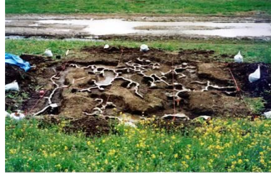
図-参 3.4 調査により可視化されたモグラ穴の実態（石膏部分）
