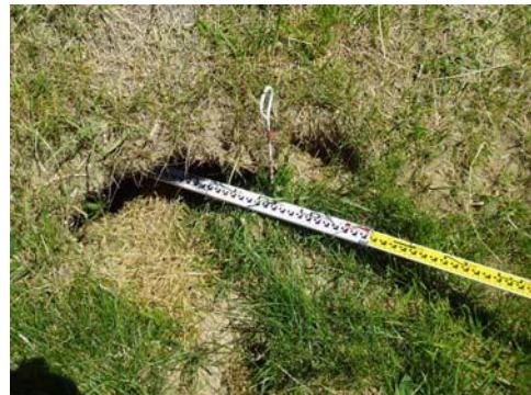
図-参 3.6 深さ 4m 近く計測されたキタキツネ穴の実態
