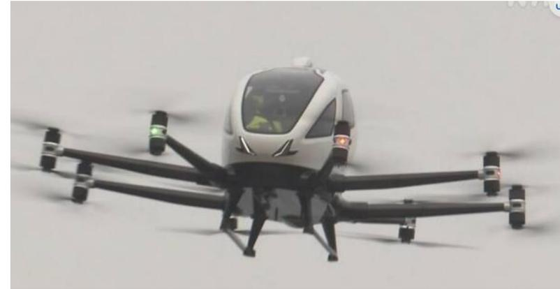
次世代の移動手段として開発が進む「空飛ぶクルマ」。17日、大分市で人を乗せた試験飛行が行われました。
