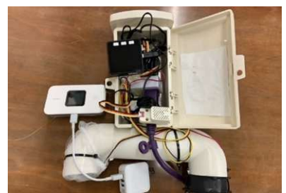
[図14] 製作した低コスト環境計測機器
