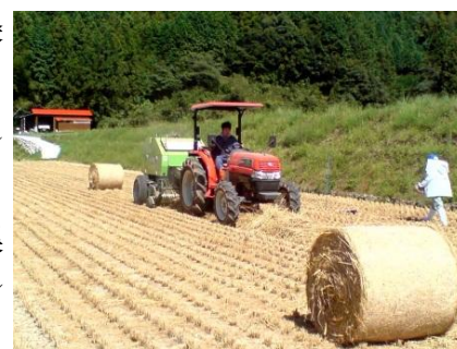
写真3 ロールベアラによる稲わらの収集
