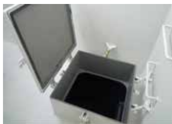
【県内造船関連企業で試作したCFRP製小型ハッチ】 ※外航船に搭載して実証試験中
