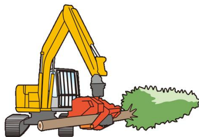
＜③プロセッサ＞ 造材(枝払い、玉伐り) をする機械
