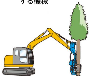
＜①ハーベスタ＞ 伐倒、造材(枝払い、玉切り) する機械
