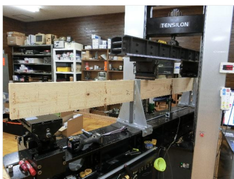
部材の曲げ試験
