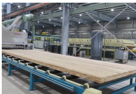
CLT製造ライン
