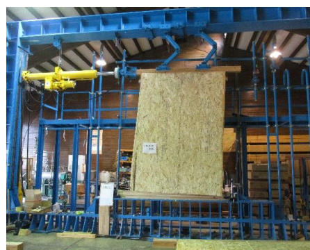
壁パネルの性能試験
